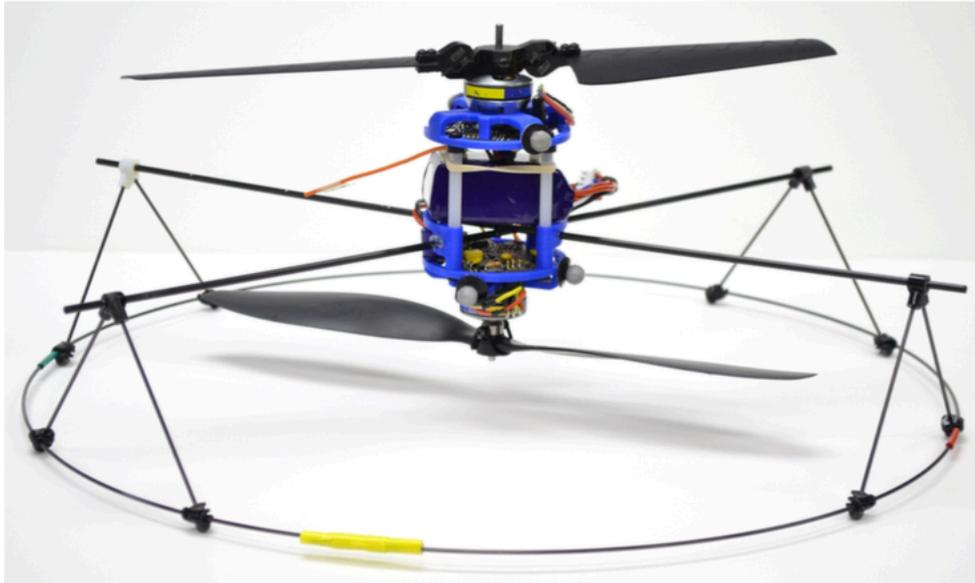
Figure 1 : Micro-drone co-axial équipé d'un propulseur innovant permettant de contrôler électroniquement et non pas mécaniquement l'orientation de la force de poussée.
