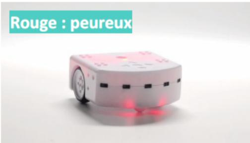
En rouge, Thymio fait du bruit quand on le touche, il nous fuit et sonne l'alarme quand il est coincé. Il sait quand il est en l'air et montre la direction de la gravité avec ses LED du dessus
