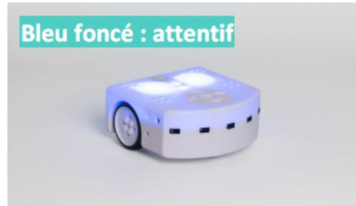
En bleu foncé, Thymio réagit au son. On peut commander le robot avec des clappements de main.
