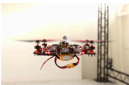
Figure 1 : Photo du drone miniature de 330 grammes X4-MaG développé au laboratoire. (Manecy et al. 2014, IEEE ROBOT, accepté)
