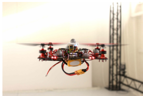
Figure 1 : Photo du drone miniature de 330 grammes X4-MaG développé au laboratoire. (Manecy et al. 2014, IEEE ROBOTIO).
