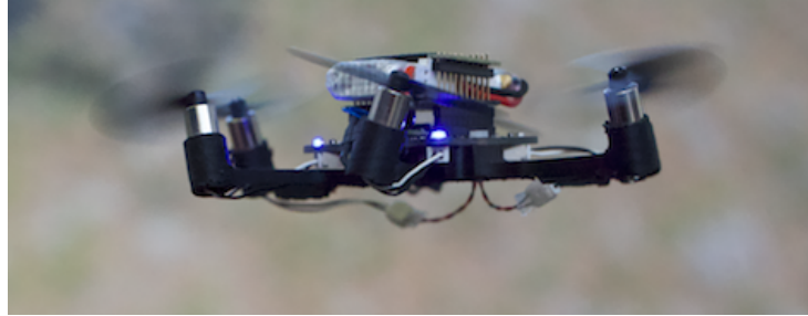
Figure : micro-hexarotor de 50 grammes ; 50-gram micro-hexarotor
