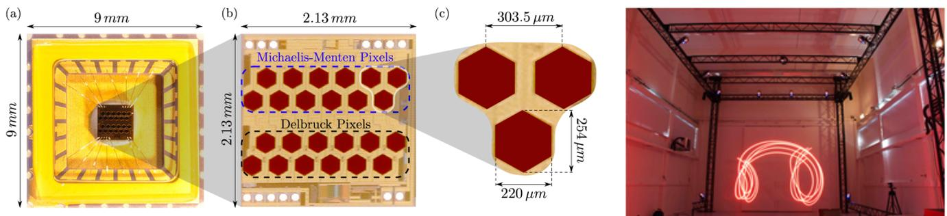
Figure 1 : a) Rétine auto-adaptative M2APIX. b) Arène de Vol.
