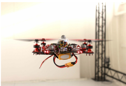
Figure 1 : Exemple d'un drone miniature de 330 grammes X4-MaG développé au laboratoire.
