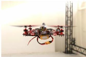
Figure 1 : Photo du drone miniature de 330 grammes X4-MaG développé au laboratoire. (Manecy et al. 2014, IEEE ROBOTICS).
